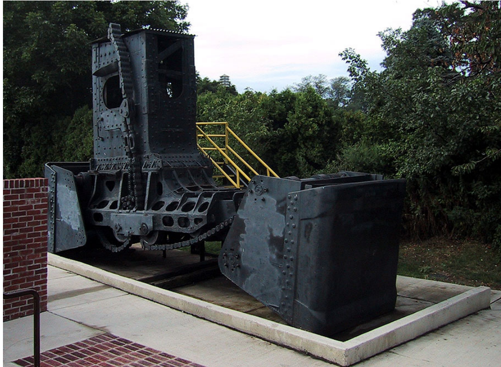
Kuva 3. Hulettin kuormaajan kauha Point Parkin puistossa: 17 tonnia 50 sekunnissa! Tämä kauhan edessä täytyi monen suomalaisenkin lapiomiehen luovuttaa. Edessä oli pitkä junamatka lännelle tai laivamatka koti-Suomeen.
